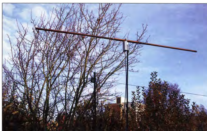
Bild 8: Im Vordergrund ist der verkürzte Dipol zu sehen, dahinter die zu Vergleichszwecken genutzte Drahtantenne.
