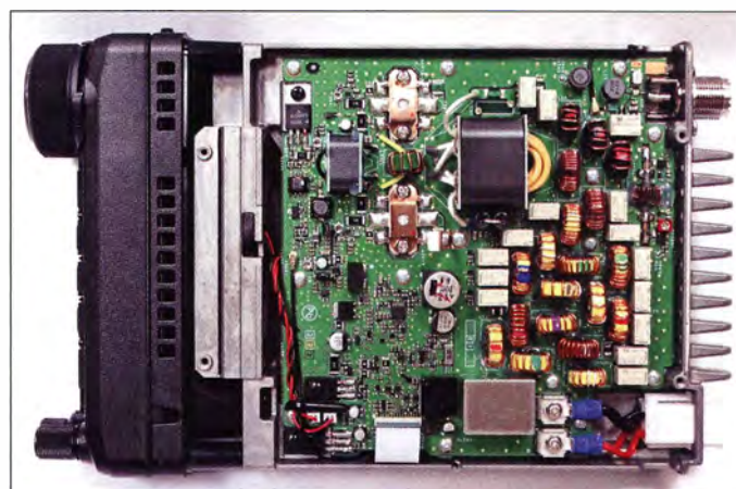
Bild 4: Blick von unten in das geöffnete Gerät auf die HF-PA-Unit mit der Senderendstufe samt Antennenfiltern
