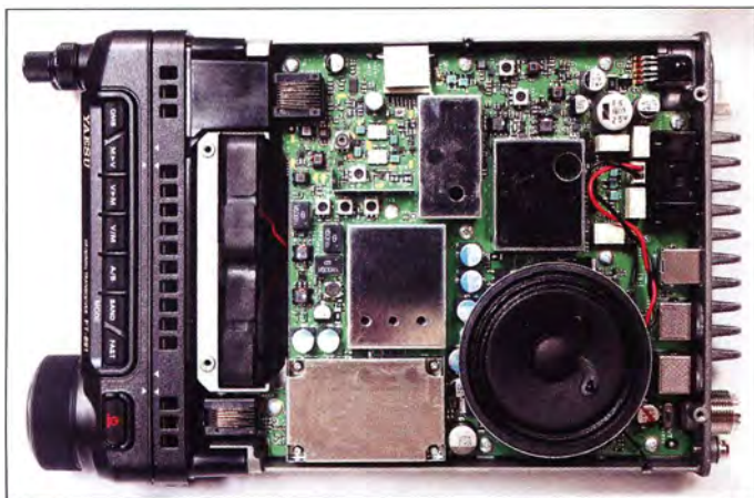
Bild 4: Blick von unten in das geöffnete Gerät auf die HF-PA-Unit mit der Senderendstufe samt Antennenfiltern
