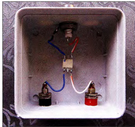
Anschlusskasten einer BOG-Antenne mit Minicircuits-Übertrager Foto: DL1AMQ
