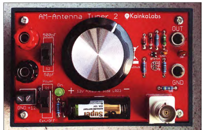
Bild 2: Abstimmgerät 2 mit herkömmlicher Abstimmung durch einen Drehkondensator
