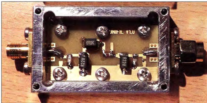
Bild 1: Fertig aufgebautes Bandpassfilter im geöffneten Aluminiumgehäuse mit SMA-Steckverbindern Foto: DG00PK
