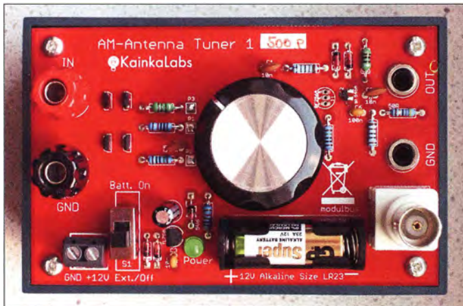
Bild 2: Abstimmgerät 2 mit herkömmlicher Abstimmung durch einen Drehkondensator
