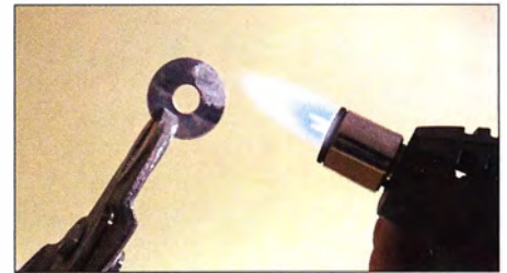
Bild 10: Beim Erhitzen von verzinkten Eisen teilen mit der Flamme eines Gasbrenners entsteht Zinkoxid.
