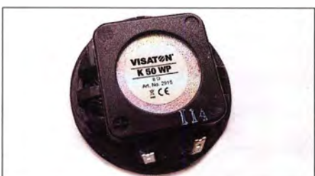
Bild 2: Für das Telegrafiefilter verwendetes Breitband-Lautsprecherchassis
