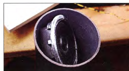
Bild 4: Einschieben des Lautsprechers in das Resonanzrohr
