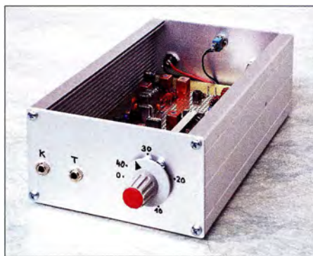
Bild 5: Frontseite mit den Buchsen für Kopfhörer und Morsetaste. Die Frequenz des QRP-Aktivitätszentrums wurde in die Skalenmitte gelegt.
