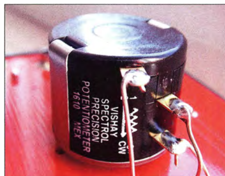
Bild 3: Platinenunterseite; 10-Gang-Wendelpotenziumeter, Abstimmgerät 1 mit Kapazitätsdioden
