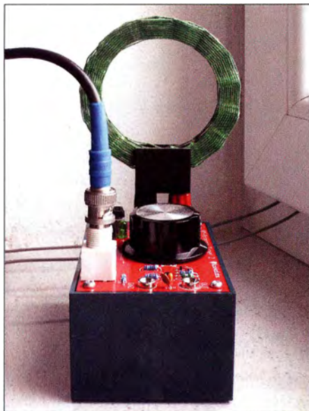
Bild 6: Abstimmgerät 2 mit 125-µH-Wabenspule für den MW-Empfang
