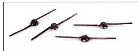
Bild 2: In meiner Sammlung alter Bauelemente fand ich noch eine Tunneldiode wie diese aus den 1960er-Jahren. Andere Typen sind auch heute noch erhältlich.
