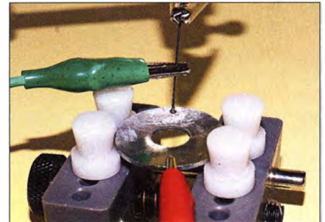
Bild 11: Die Tunnelodiode ist fertig, wenn die bearbeitete Metallplatte mit einer Stecknadel an einem auszuwählenden Punkt abgetastet wird.
