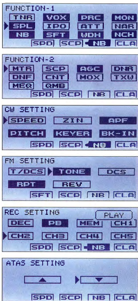
Bilder 7 bis 12: Diese sechs Einzelmenüs sind für beim Funkbetrieb häufig benötigte Funktionen bestimmt und werden mit der F-Taste aufgerufen sowie durchgeschaltet.
