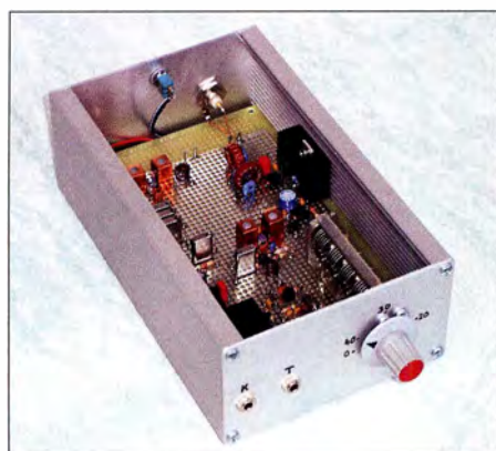
Bild 3: Der Endstufentransistor ist auf einem kleinen Kühlkörper und zusätzlich an der Seitenwand des Aluminiumgehäuses befestigt.
