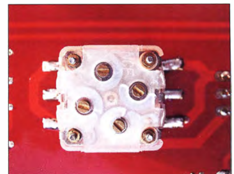
Bild 4: Platinenunterseite; Foliendrehkondensator mit vier Plattenpaketen und 500 pF Endkapazität Fotos: DF2BC
